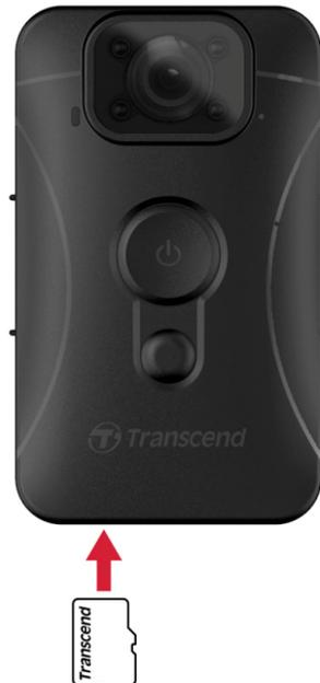
1. Inserte la tarjeta de memoria microSD en la ranura situada en la parte inferior de la cámara.
