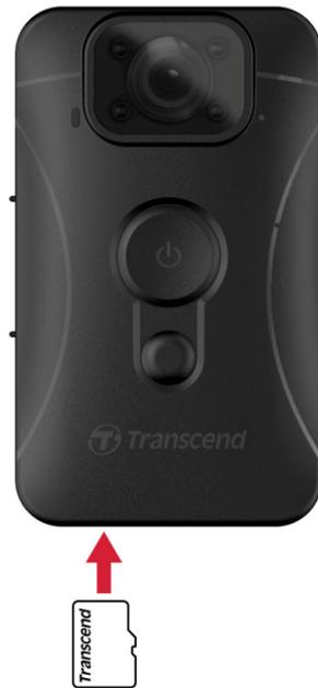
1. Setzen Sie eine Micro SD-Speicherkarte in den Kartenschlitz an der Unterseite der Kamera ein.
